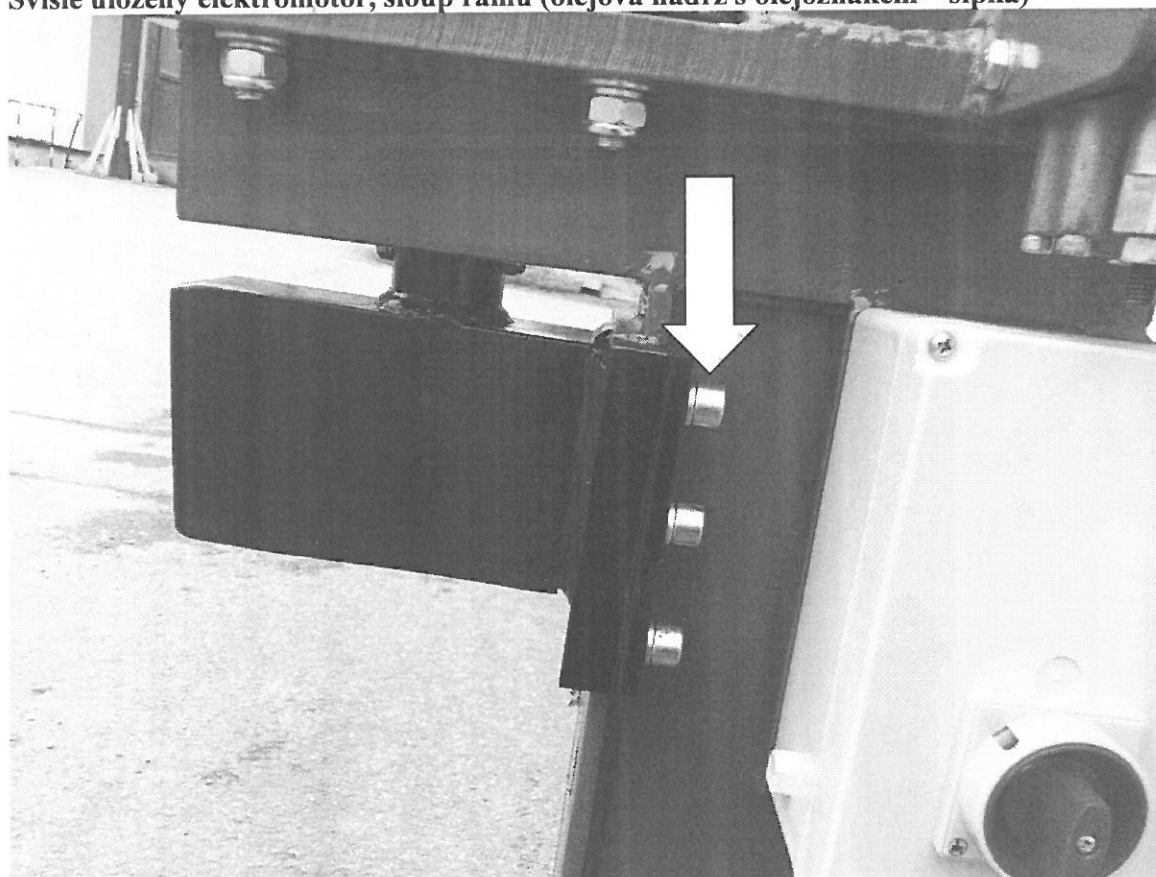
Vedení sekery, saně zajištěny šrouby - označeno šipkou
